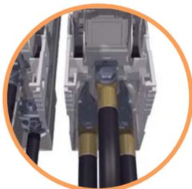
→ Подключение с помощью кабельных наконечников под винт. Также предусмотрена возможность подключения монолитного кабеля сечением до 240 мм<sup>2</sup> и гибких проводников сечением до 300 мм<sup>2</sup>.
